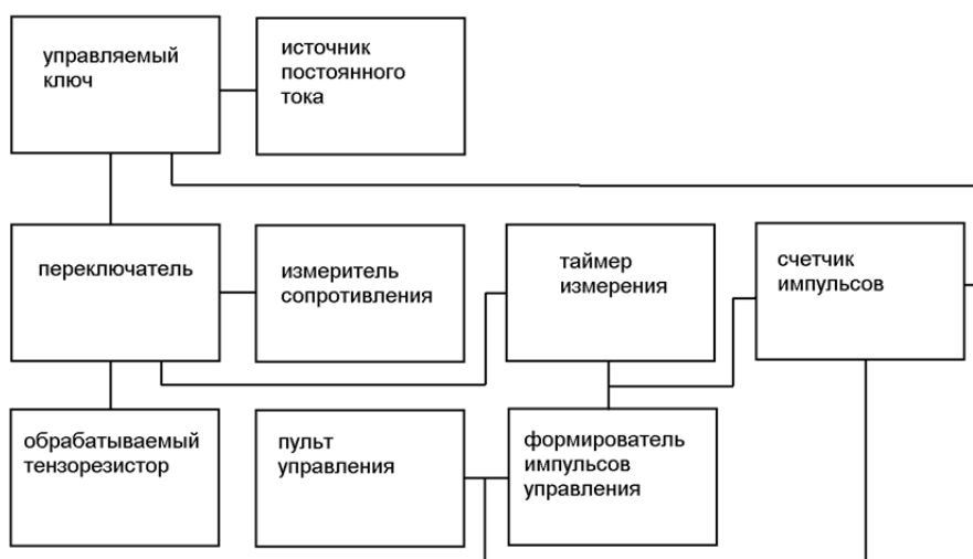
Рис. 1. Структурная схема системы стабилизации и подгонки тензорезисторов
