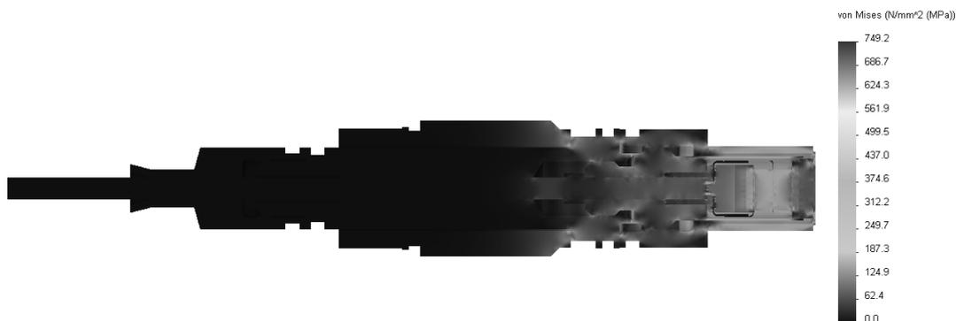
Рис. 6. Эпюра распределения напряжений при воздействии давления 125 МПа
