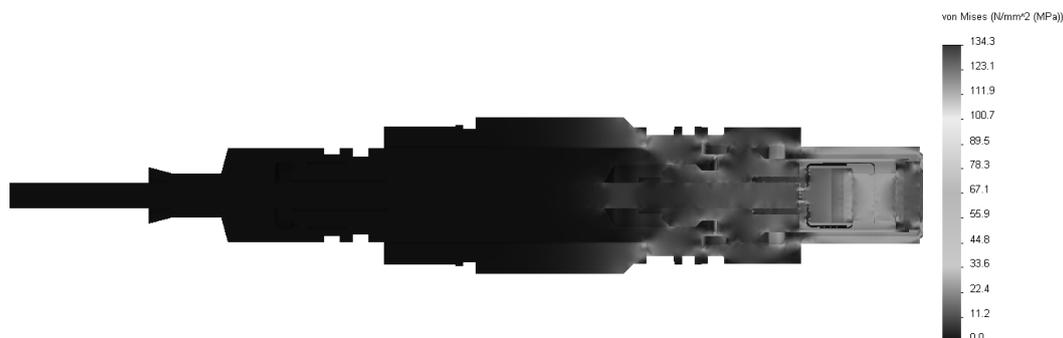
Рис. 5. Эпюра распределения напряжений при воздействии давления 22,4 МПа
