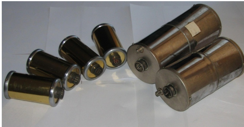
Рис. 2. Добавочные резисторы и шунты коаксиальной конструкции
