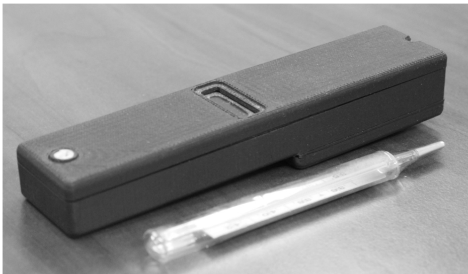
Рис. 3. Сопоставление размеров разработанного и ртутного термометров
