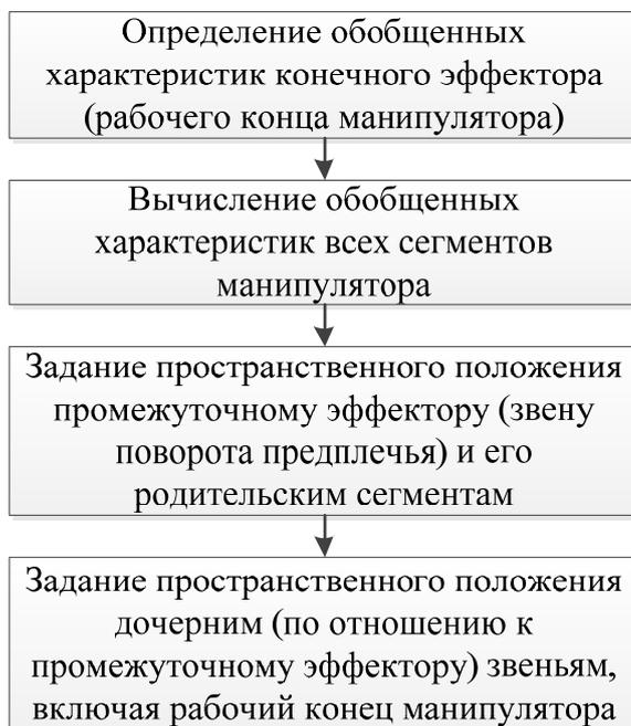
Рис. 7. Алгоритм управления механическим манипулятором
