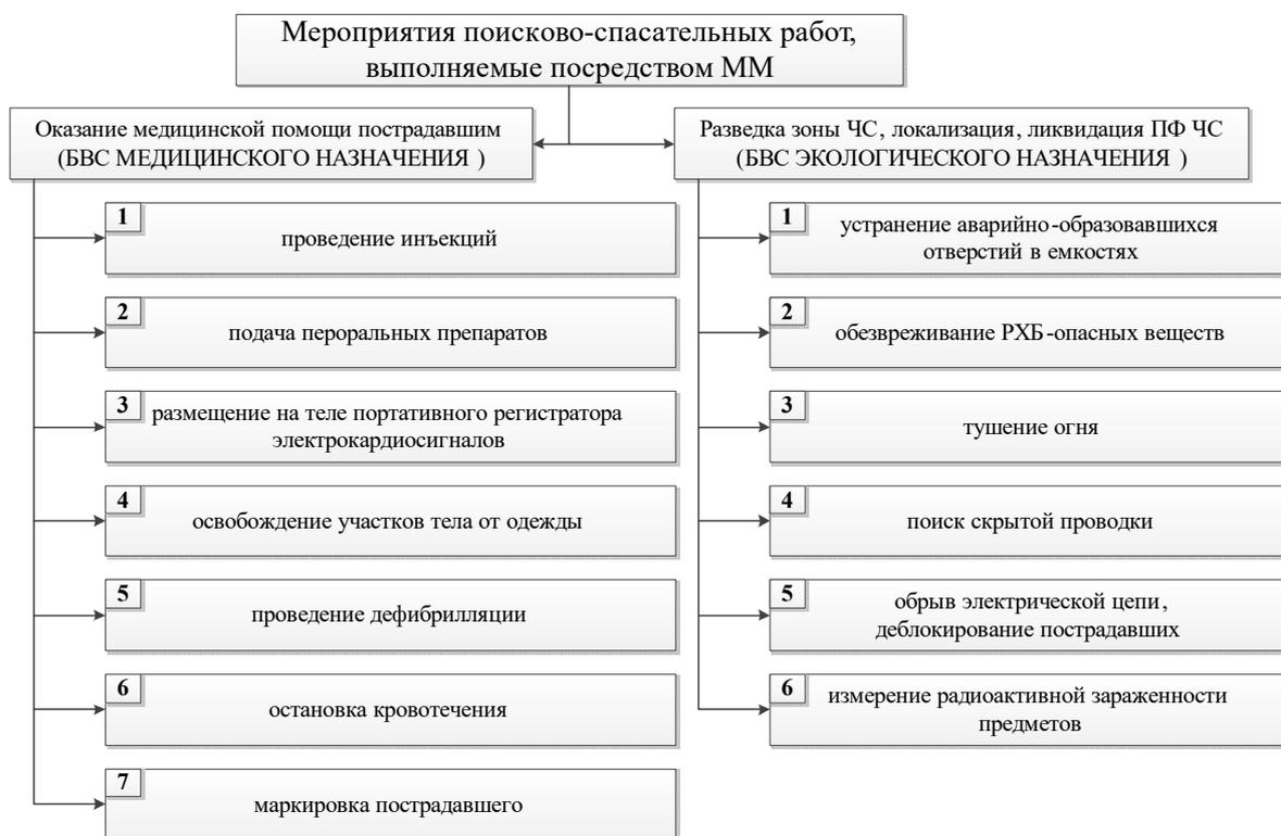
Рис. 3. Операции, выполняемые с помощью механического манипулятора
