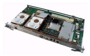
Рис. 1. Объект исследования – процессорная плата СМГ
