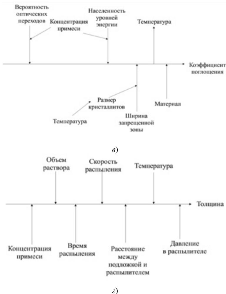
Рис. 2. Причинно-следственные диаграммы, учитывающие факторы, влияющие на следующие параметры качества ППО-покрытий: в – коэффициент поглощения; г – толщину (окончание)
