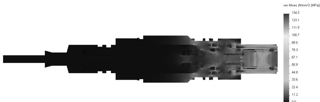
Рис. 5. Эпюра распределения напряжений при воздействии давления 22,4 МПа
