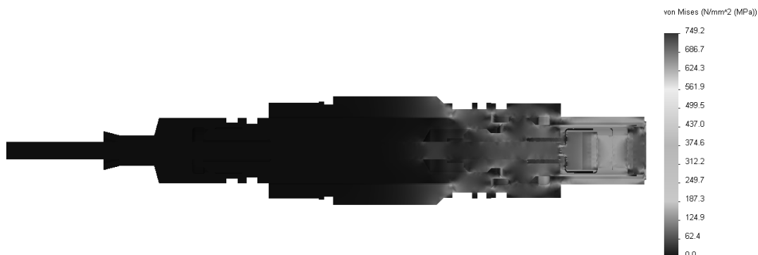
Рис. 6. Эпюра распределения напряжений при воздействии давления 125 МПа
