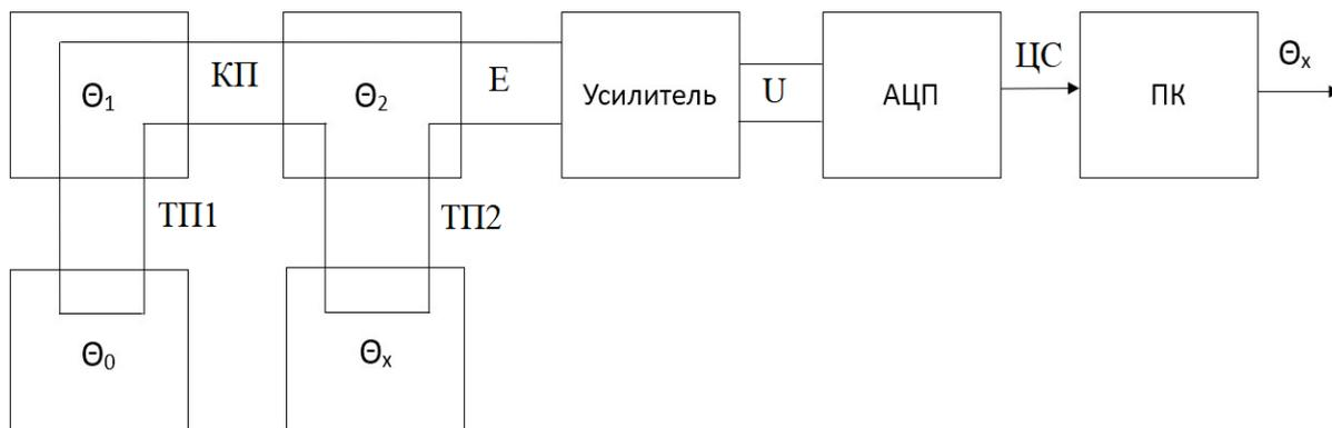
Рис. 5. Канал измерения температуры с компенсационной температурой: ТП1 – термопара; ТП2 – дополнительная термопара; КП – провода; Е – термо-ЭДС;  $U$  – напряжение; ЦС – цифровой сигнал;  $\Theta_0$  – температура термостата;  $\Theta_1$  – температура свободных концов термопары;  $\Theta_2$  – температура компенсационных проводов на конце линии;  $\Theta_x$  – измеряемая температура
