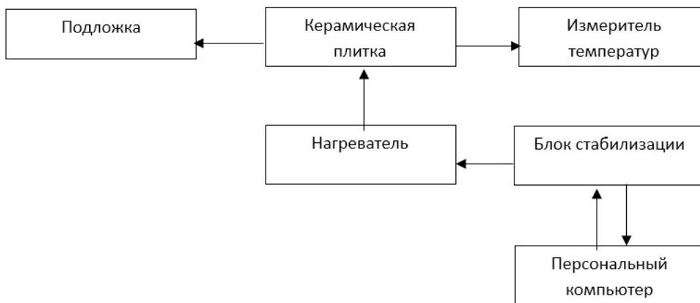
Рис. 4. Структурная схема канала нагрева и измерения температуры
