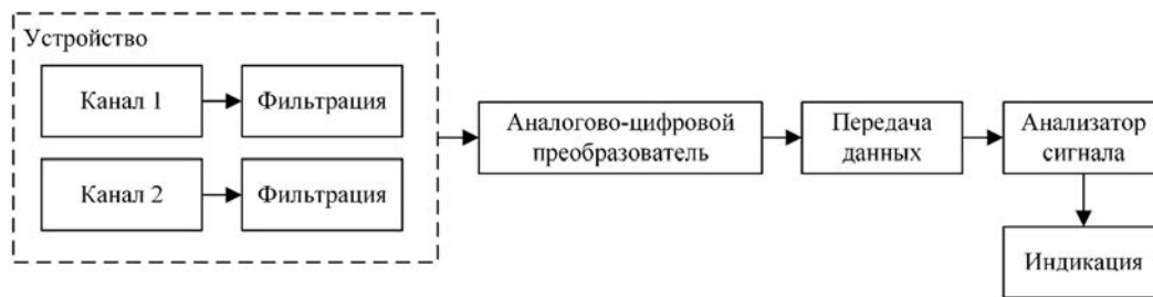
Рис. 1. Структурная схема реализации акустического метода
