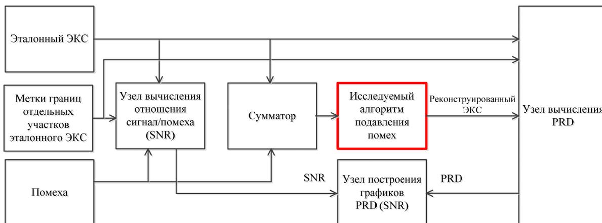
Рис. 1. Структурная схема системы тестирования алгоритмов подавления помех в ЭКС
