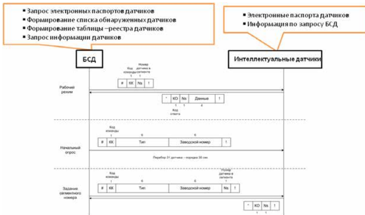
Рис. 2. Протокол информационного взаимодействия БСД с датчиками
