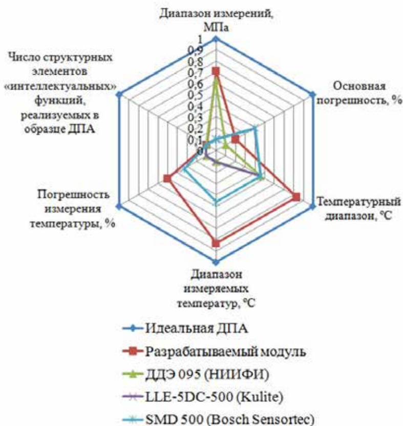
Рис. 3. Циклограмма сравнительных характеристик разрабатываемого датчика, его аналогов и идеальной датчикопреобразующей аппаратуры
