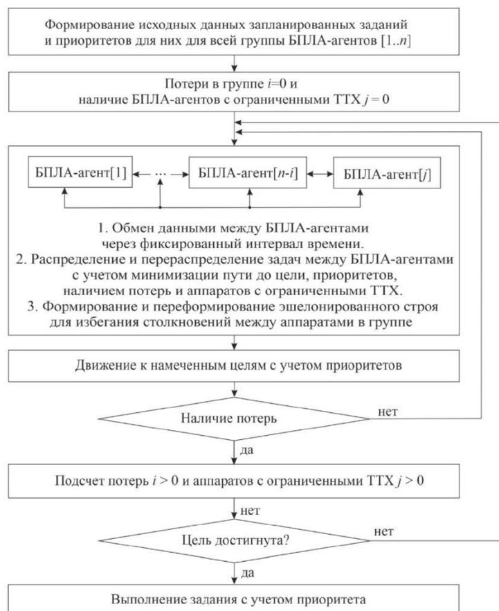
Рис. 2. Алгоритм работы мультиагентной системы управления группой БПЛА
