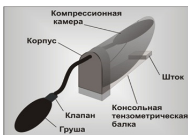
Рис. 5. Конструкция безманжетного тонометра
