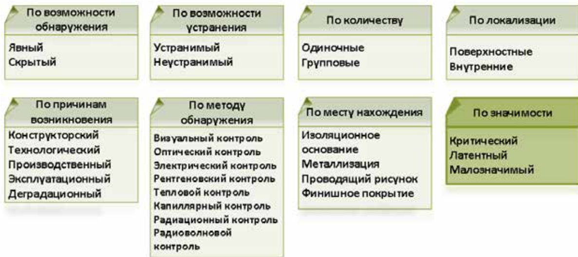
Рис. 3. Фасетная классификация технологических дефектов печатных плат
